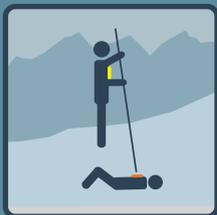
Cominciare a sondare dal punto determinato in precedenza a spirale con una distanza di 25 cm dall'interno verso l'esterno. Una volta determinata la posizione della vittima confermare con la funzione „marcare“.
