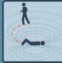
Marcare con un bastoncino la posizione dove si ha ottenuto la ricezione del segnale. Muoversi a passo veloce in direzione della freccia sullo schermo osservando che l'indicazione della distanza deve diminuire.
